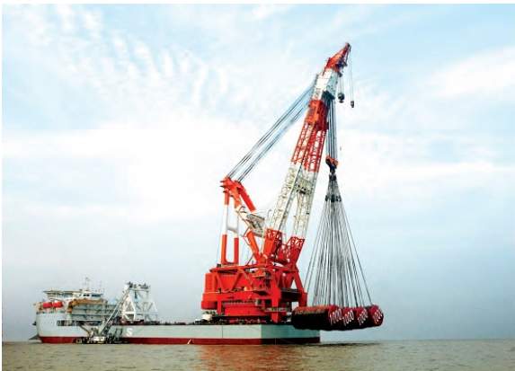
亚洲第一吊4000吨华天龙号浮吊
